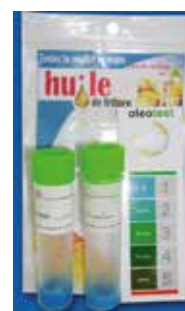
Testador de aceite (Pack 10 und.) Mide el % de Compuestos Polares.
